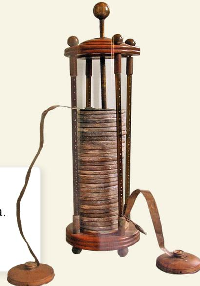
► La pila di Volta era costituita da dischi di rame e zinco, disposti uno sopra l'altro, alternati a dischi di lana imbevuti di acqua salata. Collegando con un filo metallico le due estremità, Volta riuscì a produrre corrente elettrica, cioè uno spostamento di elettroni.
