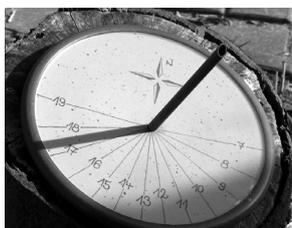
La **meridiana** è uno strumento di misurazione del tempo che si basa sul rilevamento della posizione del Sole: un'asta, detta gnomone, proietta su un quadrante la sua ombra, indicando con un buon grado di approssimazione l'ora solare. Ovviamente non è possibile con questo strumento misurare il passare dei minuti o dei secondi. Il limite principale della meridiana è di funzionare solo in presenza del Sole (di notte o con giornate nuvolose l'uso non è possibile).
