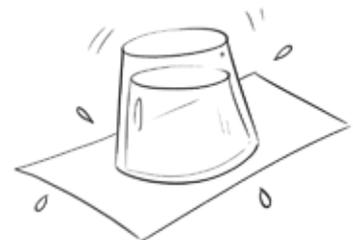
Abbiamo dimostrato che **la pressione dell'aria dal basso schiaccia la cartolina** contro il bordo del bicchiere e tiene l'acqua dentro il bicchiere. L'aria non può entrare e l'acqua non può uscire.
